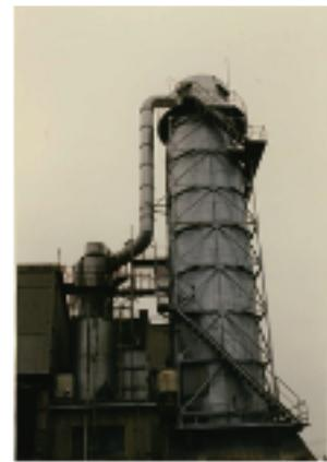
高温多湿ガスに於いては $5\text{ }\mu$ 以上の粉塵・煤塵の保障捕集効率を97w%以上で実施しております。稼動状況は実捕集効率: 99.7w%以上です。例えば、過熱水蒸気中の無機物・有機物が混在した、個々の比重に大きな差がある下水乾燥汚泥微粉の回収に於いても、入口濃度 $2\text{ g}/\text{Nm}^3$ に対して排ガス濃度が約 $0.004\text{ g}/\text{Nm}^3$ と言う高効率を発揮しております。電気ヒーター式の昇温装置を取り付けて、結露も無く、長時間の連続運転に対応しております。
