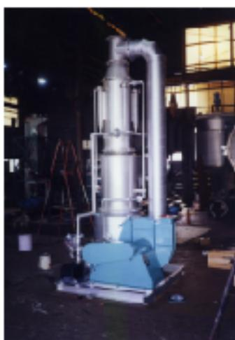
LGSミストセパレーターは産業廃液固化機の排気ガスに混入して排出する無機系の微細粉塵を洗浄除去するガス洗浄塔の塔頂に据付けて、洗浄塔からキャリオーバーするミストを除去しております。洗浄塔とLGSミストセパレーターを一体化することによって設備もシンプルに纏まります。上記のようにガス洗浄塔の塔頂に据付けた例は数多く、何れも排ガス中のミストは除去しており、煙突からの降下ミストはありません。
